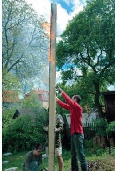
布拉格的 A1 建築師在實踐日本傳統的木材炭化技術。
