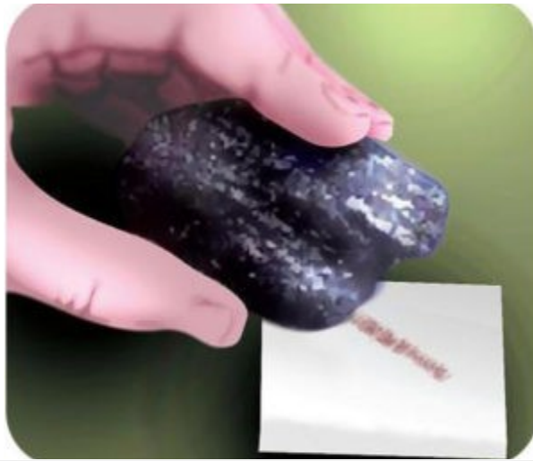
圖 5.赤鐵礦在未上釉的瓷盤上的條紋為紅褐色。
