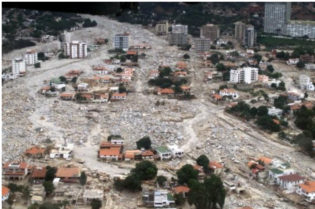
圖 1. Caraballeda 風扇上的泥石流損壞。主通道（在左側）開闢了一條新路線，該路線將其引導至右邊的房屋。這些火山沉積物厚達 6 米（20 英尺），總計約 180 萬立方米的巨石和其他材料。
