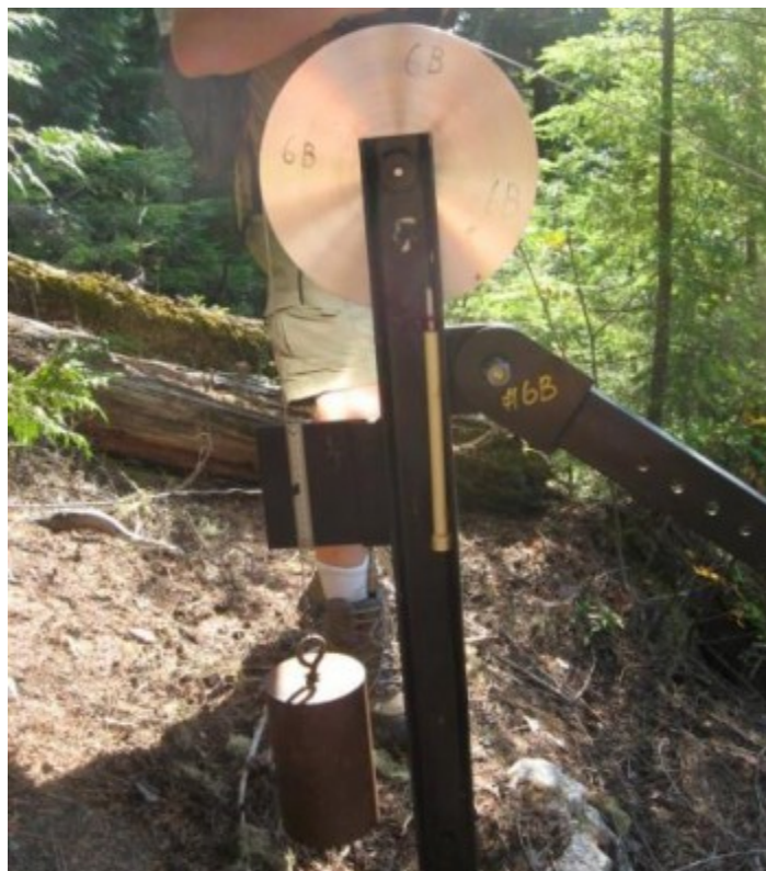
圖 3.運動監測設備的一部分，位於不列顛哥倫比亞省 Revelstoke 附近的 Checkerboard 滑軌上。電纜的下端連接到一塊不穩定的岩石上。該模塊的任何增量運動都將移動電纜，這將在此設備上檢測到。[SE]
