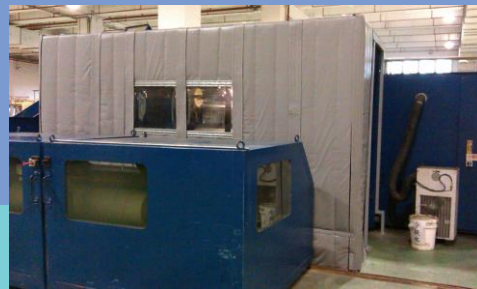
導風罩外側減速機馬達軟質防音罩設置示意圖
