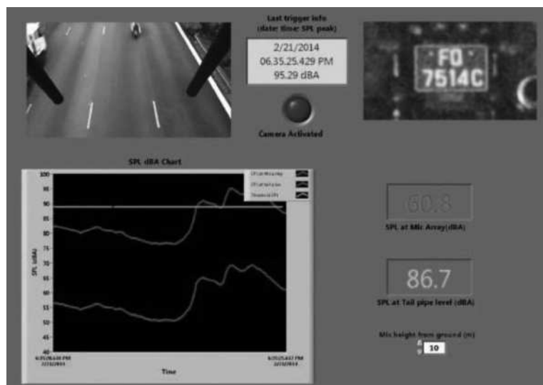
圖 11.7-7 GUI 面板顯示最新擷取的巔峰 SPL 讀數、日期 & 時間、車牌相片、和錄影片段。麥克風陣列的 SPL 和距離排氣管高度 0.5 m 處的推估 SPL 均即時顯示，同時顯示既定的 SPL 閾值
