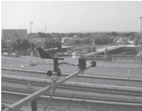
圖 11.1-6 支撐桿 - 延伸作業
