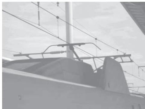
圖 3.1-3 集電弓與集電系統示意圖
