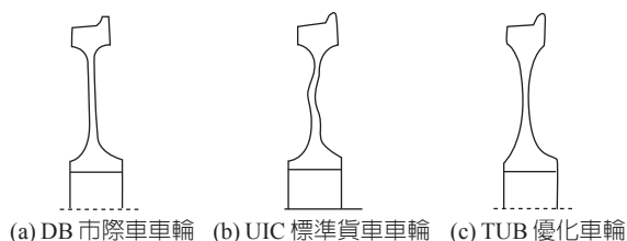
圖 3.3-1 各種形式的最佳化車輪橫截面形狀
