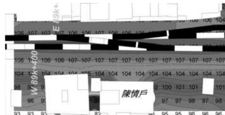
圖 3.6-5 未進行隔音牆改善前 2 樓處等音線模擬圖
