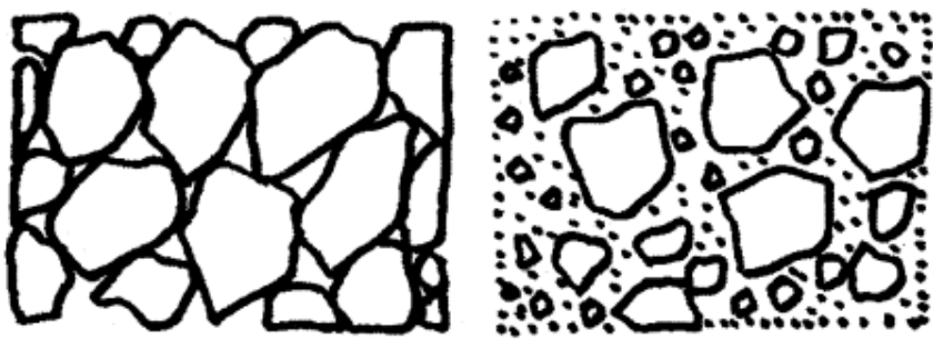
ポーラスアスファルト舗装と密粒 アスファルト舗装の断面比較
