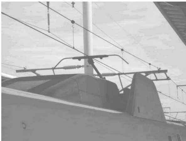
圖 3.1-3 集電弓與集電系統示意圖
