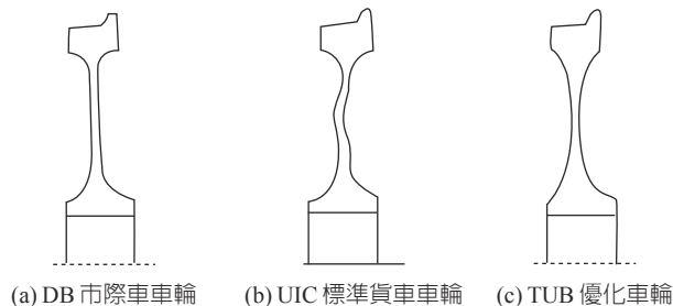
圖 3.3-1 各種形式的最佳化車輪橫截面形狀
